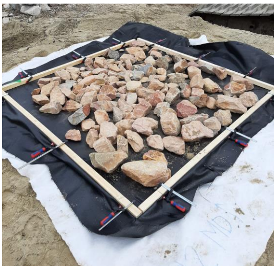
Figuur 1 Testsecties voor geotextiel met frame (boven-links), zand (boven-rechts) en enkele laag van de sortering (onder)
