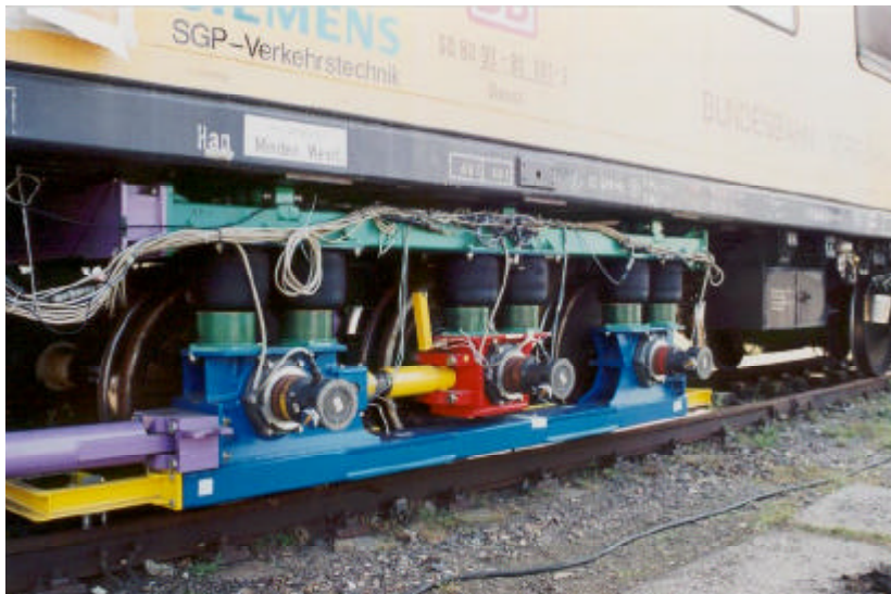
Foto 7. Dysaf meetwagen met geïnstrumenteerd meetdraaistel
