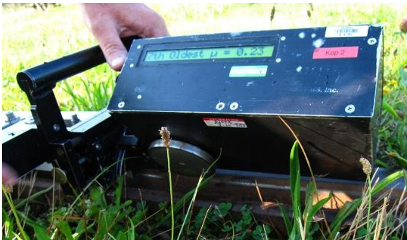
Foto 4: RailTribometer ingezet op een meetlocatie op lijn 19 (groefrail in grasbaan).
