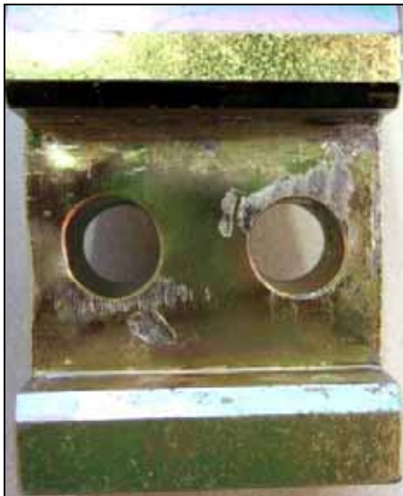
Afb.17: Zijaanzicht van de bevestiging van het blok met de stellerstang
